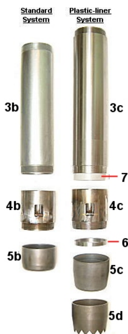
Слика 2.4: Конструкција стандардног и цилиндра са пластичном облогом типа U100
